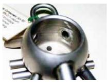
MILKING MACHINE PUMP COMPONENT NICROBRAZ® LC BNi-1a
